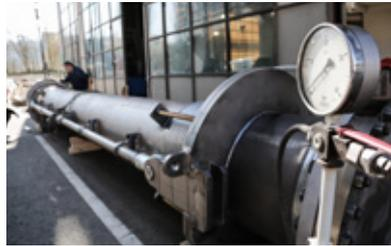
TÜV 检测 7 米长构件的压力试验
