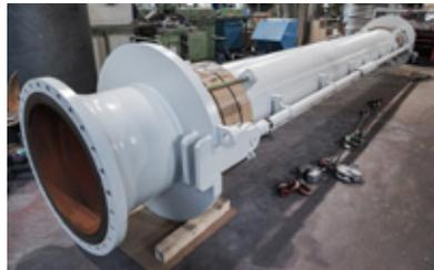
外部多层环氧化物涂层作为防腐蚀保护
