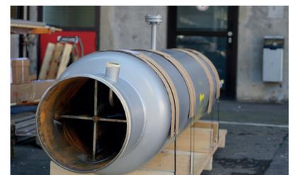
Erkennbar ist die Balgentlüftung des inneren Druckra-
