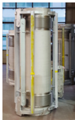
DN 800, PN 16 und 3.200 mm hoch. Aufgabengebiet: Bewegungskompensation in der Nitrosegasleitung
