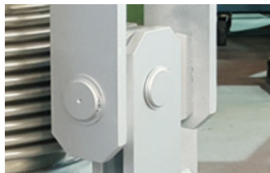
PTFE Buchsen an den Verankerungen minimieren die Reibung und somit die Verstellkräfte
