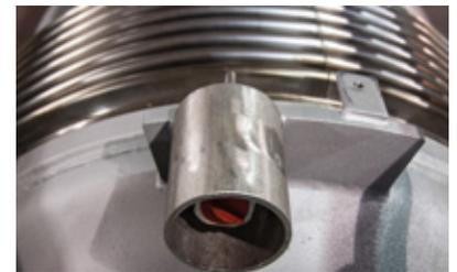
波纹管集成的泄漏监控装置（带保护管）
