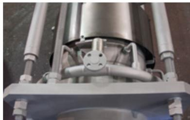
顶部环形管道，带喷管，用于吹入蒸汽
