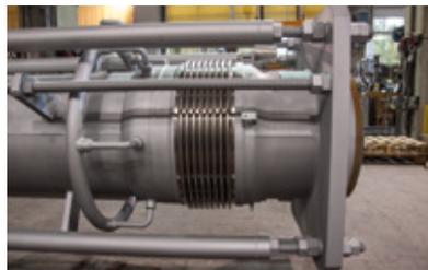
环形管道装配在内部波纹管保护管的后侧。
