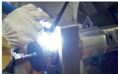
*Manuelles Schweißen der Spezialflanschverbindung*
