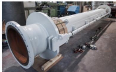
Eine mehrlagige äußere Epoxydschicht als Korrosionsschutz
