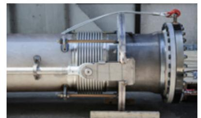
Blindflansche für die aufwändige Druckprüfung
