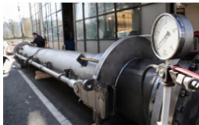
TÜV-überwachte Druckprüfung des 7 Meter langen Bauteiles mit 28 bar
