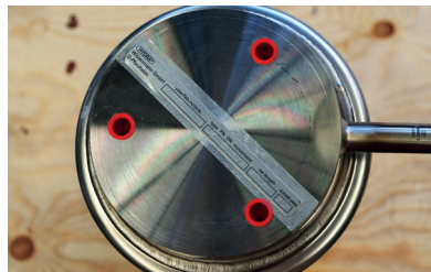
Mittels drei Gewinde-Sackbohrungen werden die Kompensatoren auf einer speziellen Halteplatte befestigt
