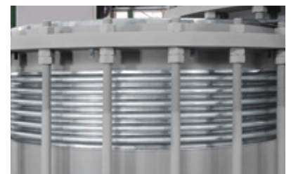
Insgesamt 12 Balgwellen sorgen für die notwendige Dehnungsaufnahme
