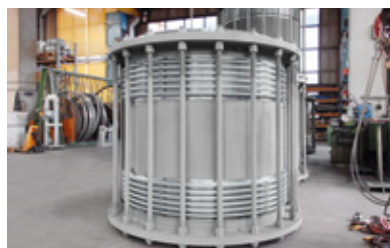
Umlaufende Rundverankerung zur Aufnahme der Druckreaktionskräfte
