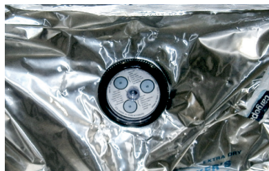
Ein Feuchtigkeitsmesser überwacht kontinuierlich die Luftfeuchtigkeit im Inneren der Verpackung.
