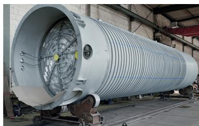
Um über die gesamte Geometrie eine konstante Mediumtemperatur zu erreichen, werden auch die Böden der Tanks „beheizt“. Der flexible Schlauch lässt sich dabei leicht an die gebogene Form des Klöpperbodens anpassen.
