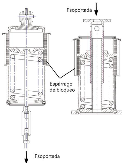
Los soportes se montan bloqueados. Todos los esfuerzos debidos a producto y aislamiento, otras cargas, actúan sobre los soportes. Tras retirar la correa de sujeción (sujeción para el transporte) de los soportes, los elementos de bloqueo introducidos en la ranura de la carcasa (tamaños 01-11, 2 piezas; tamaños 12-16, 4 piezas) deberán retirarse con la mano.
