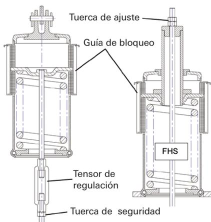
En primer lugar, el anclaje de carga inferior (barra roscada) debe enroscarse en el tensor de la suspensión y unirse a la carga a soportar (considérese la dimensión de sistema del tensor; engrasar bien ambas roscas del tensor y enroscar previamente las tuercas de segu-
