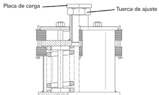
La placa de carga con rosca se inserta suelta. Se aprieta girando la tuerca de ajuste (antes, engrasar la rosca) (capacidad de ajuste + 30 mm). Con soportes a partir del tamaño 08, la placa de carga debe aflojarse con las herramientas auxiliares adecuadas (como medios de elevación y elevadores hidráulicos).
