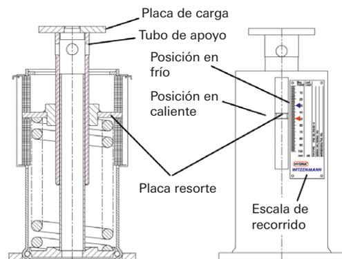
La placa de carga con collarín se inserta suelta. Se tensa girando el tubo de apoyo (antes, engrasar la rosca) (capacidad de ajuste + 30 mm). Con soportes a partir del tamaño 08, la placa de carga debe aflojarse con las herramientas auxiliares adecuadas (como medios de elevación y elevadores hidráulicos).
