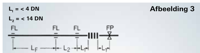
Afstanden glijsteunen bij buisleidingen met axiale compensatoren
