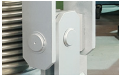
在铰链板上用于最小化摩擦力以及调整应力的 PTFE 衬套
