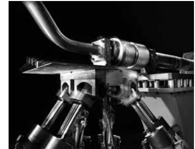
Bild 2.5 Schwingungsprüfungs-Stand zur Simulation komplexer Anwendungsbedingungen.
