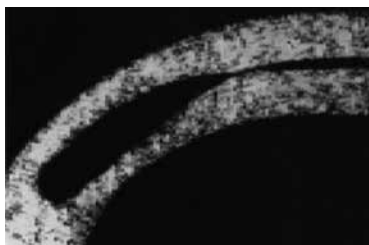
Bild 18.6 Spaltkorrosion an einem Kaltband aus austenitischem Stahl. Schnittbild (50-fache Vergrößerung)
