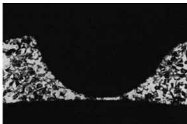
Bild 18.1 Lochkorrosion am Kaltband aus austenitischem Stahl. Schnittbild (50-fache Vergrößerung)
