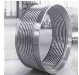
Bild 8.6 Axial-Kompensator aus Alloy 825 für Wärmetauscher (DN 1200/PN 40)
