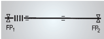
Bild 9.5 Asymmetrische Anordnung des Kompensators. Reibkraft auf einen Festpunkt.
