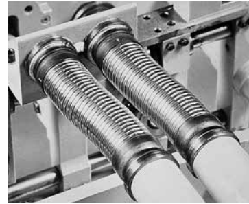
Bild 2.6 Wechselbiegemaschine zur Ermittlung des Ermüdungsverhaltens von dünnen Bändern und Blechen.
