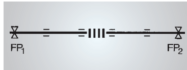
Bild 9.6 Symmetrische Anordnung des Kompensators. Reibkraft gleichmäßig verteilt.
