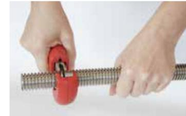
1. Schlauch auf gewünschte Länge im Wellental mit einem Rohrab-schneider ablängen.
