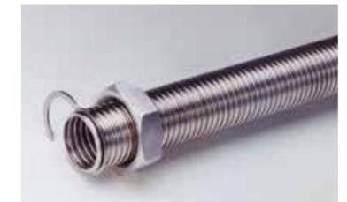
6. Klemmring in das erste Wellental einlegen und zu einem geschlos-senen Ring zusammendrücken. Überwurfmutter zurückschieben, Dichtung einlegen, Einschraubteil aufsetzen und mit zwei Sechskant-schlüsseln anziehen.\*
