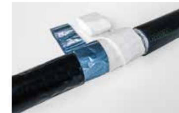
2. Wickeln Sie zunächst die hitzereflektierende Folie mit 25% Überlappung um Schlauch und Armatur. Wickeln Sie dann das Glasfaserband um Schlauch und Armatur (50% Überlappung). Zuletzt nochmals die hitzereflektierende Folie 25% überlappend.
