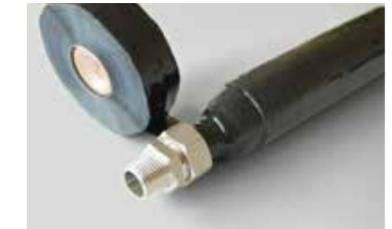
3. Tragen Sie großzügig Silikonkleber auf das Ende (mindestens 5 cm) der Isolierung auf. Umwickeln Sie das Ende mit dem schwarzen Silikonklebeband mit einer Überlappung von 50%. Starten Sie dabei minimum 5 cm oberhalb der abgeschnittenen Isolierung auf dem schwarzen Mantel. Entfernen Sie das transparente Schutzpapier vom Silikonklebeband erst kurz vor der Anbringung.
