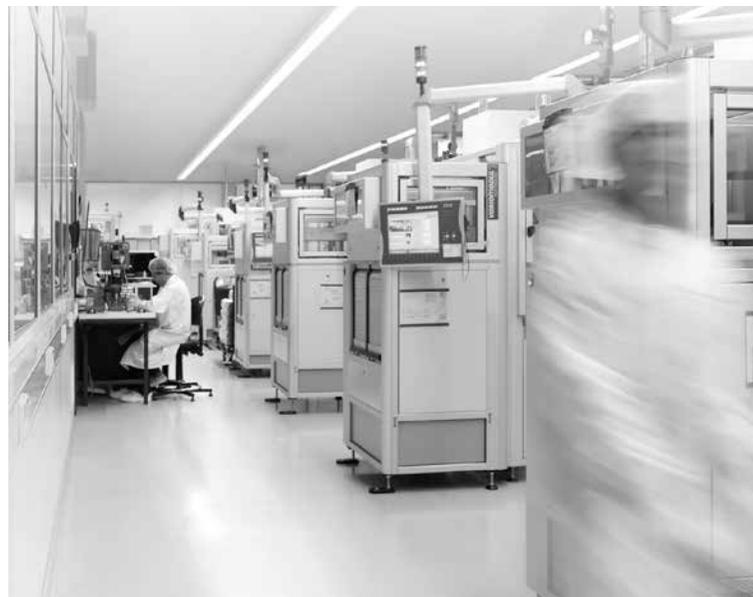
Bild 2.2.2.: HYDRA Präzisionsbälgefertigung unter Reinraumbedingungen
