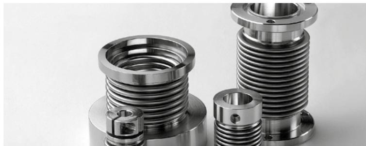
Metallbälge sind torsionssteif und gleichzeitig biegeweich. Damit bietet sich ihr Einsatz als wartungsfreie Wellenkupplung (Bild 3.9.1.) zur Drehmomentübertragung und zum Ausgleich von Lagetoleranzen an. Metallbalgkupplungen werden auf Torsion und auf Umlaufbiegung belastet. Für letztere ist eine dauerfeste Auslegung erforderlich.
