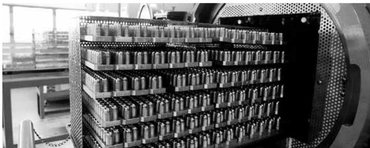
Ähnlich einem Kolben wandeln Metallbälge Druck in Kraft oder Bewegung um und umgekehrt. Damit können sie als Sensoren und Aktoren verwendet werden, deren Kennlinie durch Federrate und hydraulischen Querschnitt des Balges definiert wird. Hauptanforderungen an Sensoren und Aktoren sind Hysteresefreiheit und Konstanz der Kennlinie, so dass auch hier aushärtbare Balgwerkstoffe vorteilhaft eingesetzt werden können.
