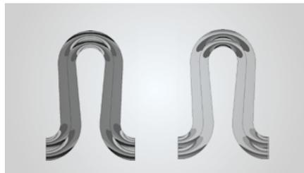
Bild 4.2.1.: Meridionalspannungen an einem zweilagigen Metallbalg bei axialer Zug- (links) und bei Außendruckbelastung (rechts)
