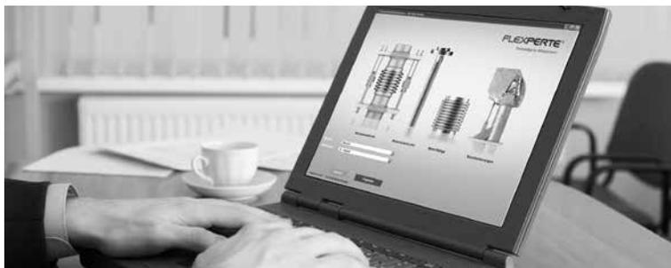
Flexperte ist eine Auslegungssoftware für flexible metallische Elemente. Sie ist eine speziell entwickelte Software, die für den Bedarfsfall geeignete Produkte aus den Standardbaureihen auswählt. Neben der Auswahl von Metallbälgen kann der Anwender mit dem Programm auch Kompensatoren, Metallschläuche und Rohrhalterungen auslegen.
