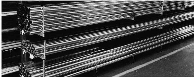
HYDRA-Präzisionsrohre sind nach Durchmesser und Wanddicke sortiert. Die maximale Lieferlänge eines Rohres beträgt 6,50 Meter; kürzere Stücke sind in beliebiger Länge beziehbar. Die Toleranzen für Rohrdurchmesser und Länge liegen im Bereich von  $\pm 0,1$  mm. Standardwerkstoff ist 1.4571, andere Werkstoffe sind auf Anfrage lieferbar.
