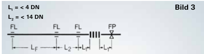
Führungsabstände von Rohrleitungen mit Axial-Kompensatoren
