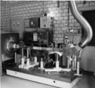
Banc d'essai de cycle de charge, pour gaines d'aspiration des gaz d'échappement à une température jusqu'à 1100 °C.
