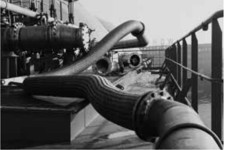
Tuyau onduleux annelé HYDRA DN 250 sur un pétrolier LNG
