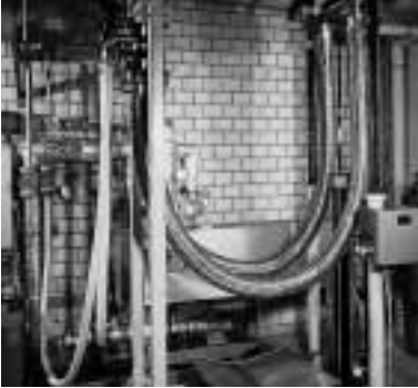
Banc d'essai de cycle de charge pour flexibles de grandes dimensions disposés en U sous pression intérieure et température du fluide allant jusqu'à 300 °C.
