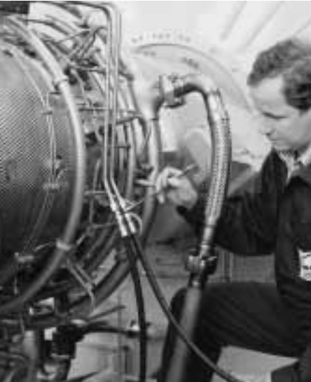
Tuyau onduleux annelé HYDRA de type RS sur une turbine Photo usine: MAN, Augsburg
