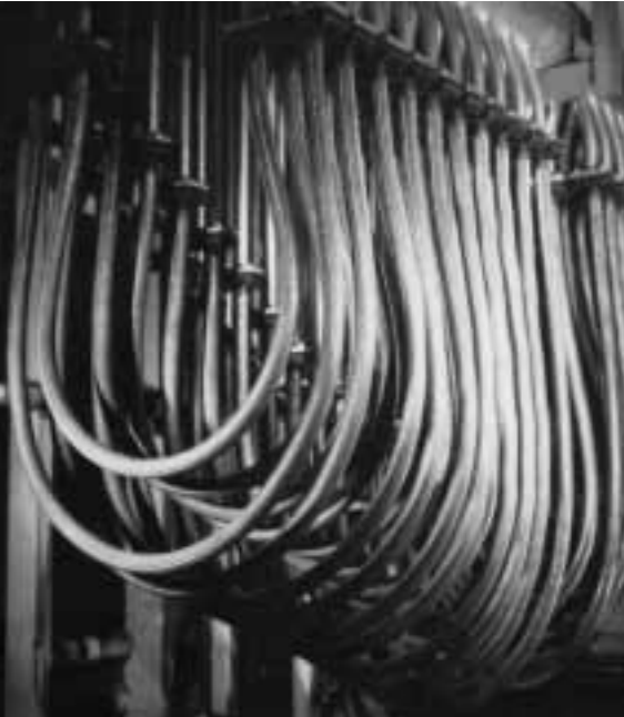
Tuyau onduleux annelé HYDRA de type RS dans une presse à plusieurs étages, monté à 180°.
