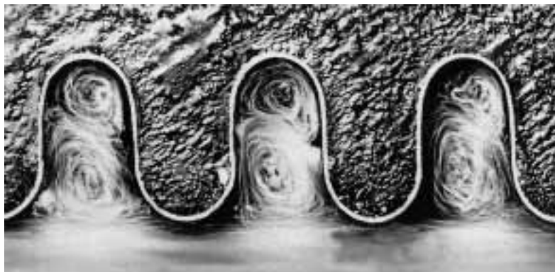
Remous primaires et secondaires en flux turbulent dans un tuyau onduleux HYDRA (Photo usine).
