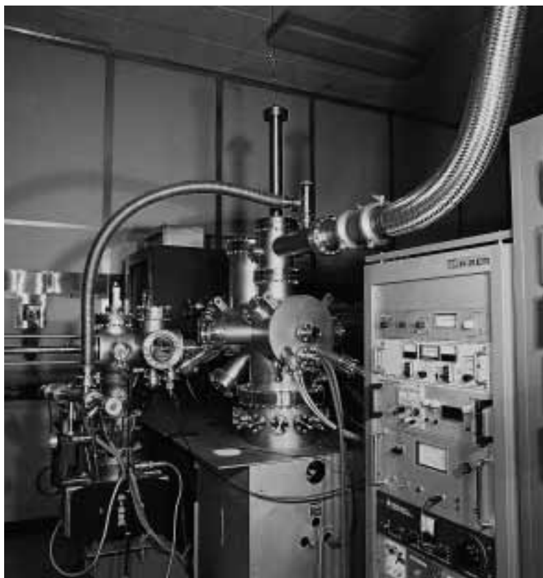
Flexibles métalliques HYDRA à vide poussé avec brides circulaires Photo usine: université d'état de Gent
