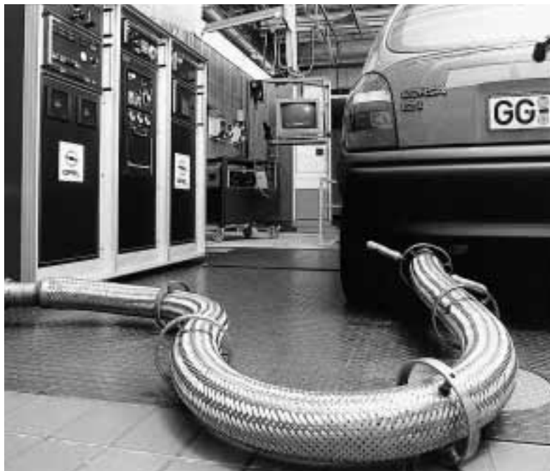
Tuyau onduleux avec tresse sur un banc d'essai moteur Photo usine: Opel
