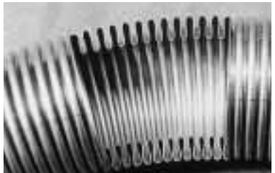
Coupe de profil au niveau de la courbure d'un tuyau onduleux annelé
