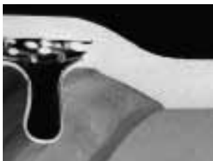
Coupe du côté raccordement, réalisation sans bavure ni interstice
