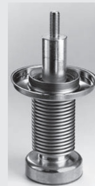
Bild 3.3.1.: Hochstromschalter mit Metallbalgabdichtung erreichen zu können. Bälge für Vakuumventile werden mit ihren Anschlussteilen verschweißt. Für einen sicheren Evakuierungsvorgang ist eine spaltfreie Ausführung der Schweißnähte vorteilhaft, bevorzugt kommen daher J-
