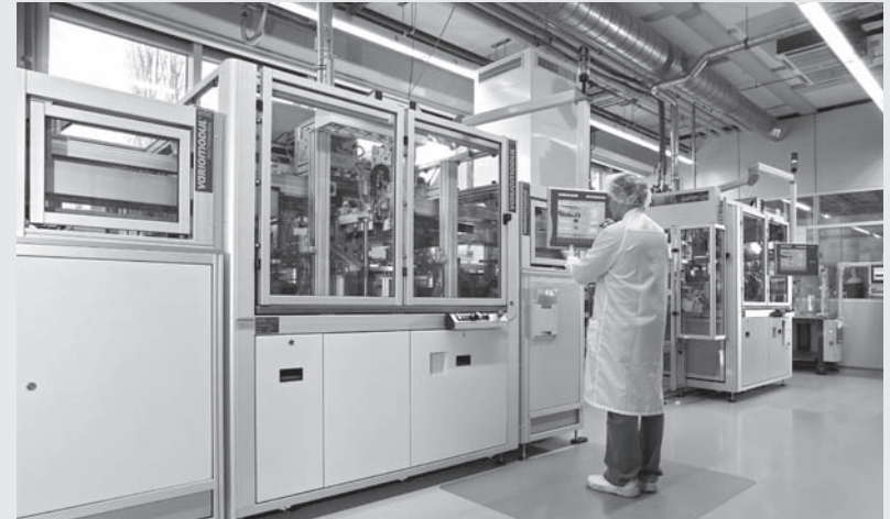
Bild 2.2.2.: HYDRA-Präzisionsbälgfertigung unter Reinraumbedingungen
