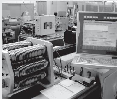
Bild 5.2.2.: Axiale Lastspielprüfung.
