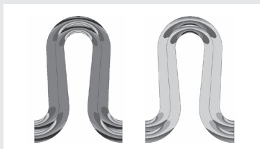
Bild 4.2.1.: Meridionalspannungen an einem zweiwandigen Metallbalg bei axialer Zug- (links) und bei Außendruckbelastung (rechts)
