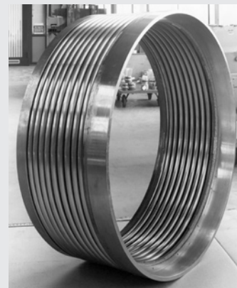
Рис. 8.6 Осевого компенсатора из сплава Инконел 825 для теплообменников (DN 1200/ PN40)
