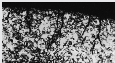
Транскристаллитное коррозионное растрескивание под напряжением на холоднокатаной полосе из аустенитной стали. Вид в разрезе, увеличенный в 50 раз.
