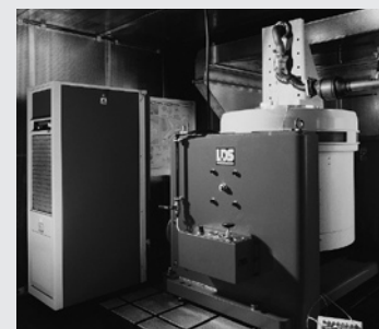
Рис. 2.5 Вибрационный испытательный стенд для имитации сложных условий применения.
