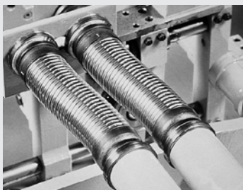
Рис. 2.6 Устройство для определения усталостной прочности (срока службы) при знакопеременном изгибе тонкостенных металлических полос и листов
