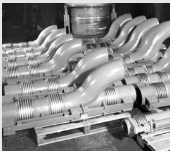
Рис.8.2 Компенсатор, уравновешенный по давлению.
