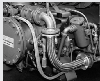
Рис. 13.11 Металлорукав с изгибом 90° на винтовом компрессоре
