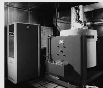
Rysunek 2.5 Stanowisko do kontroli przejmowania drgań, umożliwiające symulację złożonych warunków eksploatacji.
