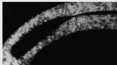
Korozja szczelinowa na taśmie zimnowalcowanej ze stali austenitycznej. Przekrój w powiększeniu 50-krotnym.
