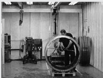
Rysunek 2.7 Badanie radiograficzne jako przykład badania nieniszczącego.
