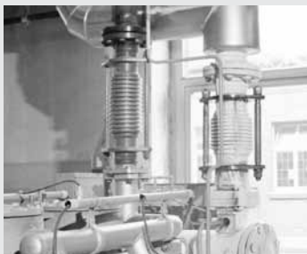
Rysunek 13.13 Kompensator boczny z z cięgnami na drgającym agregacie.
