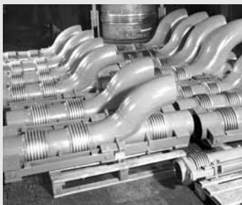
Rysunek 8.2 Kompensator odciążony ciśnieniowo
