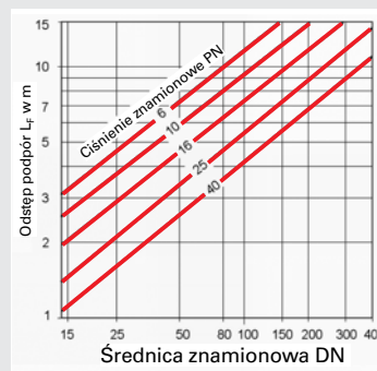
Rysunek 16.4 Zalecane odstępy między podporami w przypadku rurociągów z kompensacją osiową.
