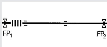
Rysunek 9.5 Asymetryczne rozmieszczenie układu kompensatorów. Siła tarcia skoncentrowana w jednym punkcie stałym.
