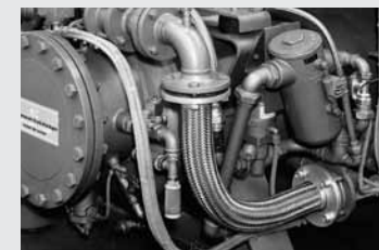
Rysunek 13.10 Wąż metalowy ustawiony pod kątem 90° na sprężarce śrubowej.
