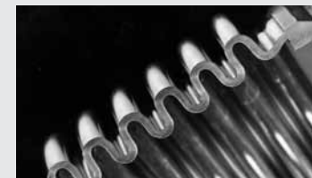
Rysunek 3.18 Mieszek wielościankowy (przekrój).
