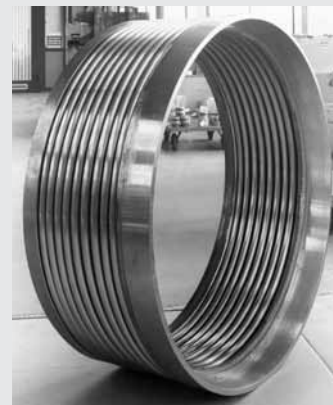
Rysunek 8.6 Kompensator osiowy ze stali Inconloy 825 do wymienników ciepła (DN 1200/PN 40).
