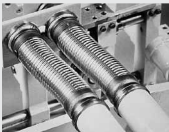
Rysunek 2.6 Gietarka sterowana cyklicznie, stosowana do prób zmęczeniowych cienkich taśm i blach.
