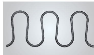
Bild 3.12 mehrwandiger Balg
