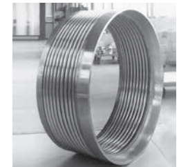
Bild 8.6 Axial-Kompensator aus Alloy 825 für Wärmetauscher (DN 1200/PN 40)
