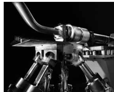
Bild 2.5 Schwingungsprüfungs-Stand zur Simulation komplexer Anwendungsbedingungen.
