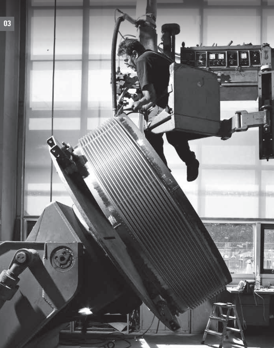
Bild 3.1 Axial-Kompensator
